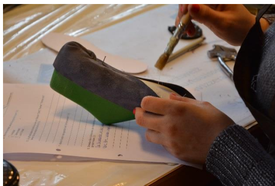
Ein Arbeitsschritt bei der Schuhproduktion ist das Anzwicken des Schaftes an die Brandsohle.
